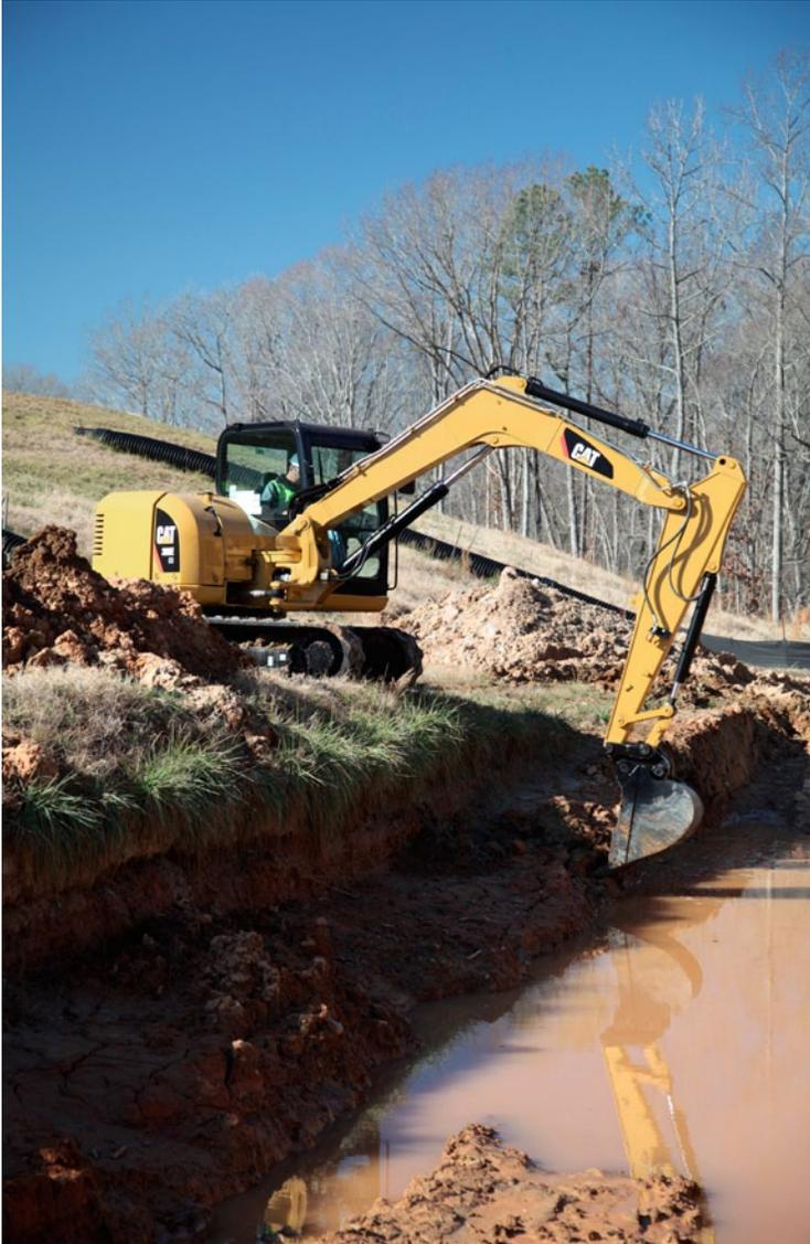
Hohe Grabkräfte für stark verdichtete Böden in Verbindung mit direkter, ruckfreier Steuerung durch eine schnell ansprechende Hydraulik gewährleisten, dass der Cat 308E CR SB die von den Kunden erwartete Produktivität liefert.
