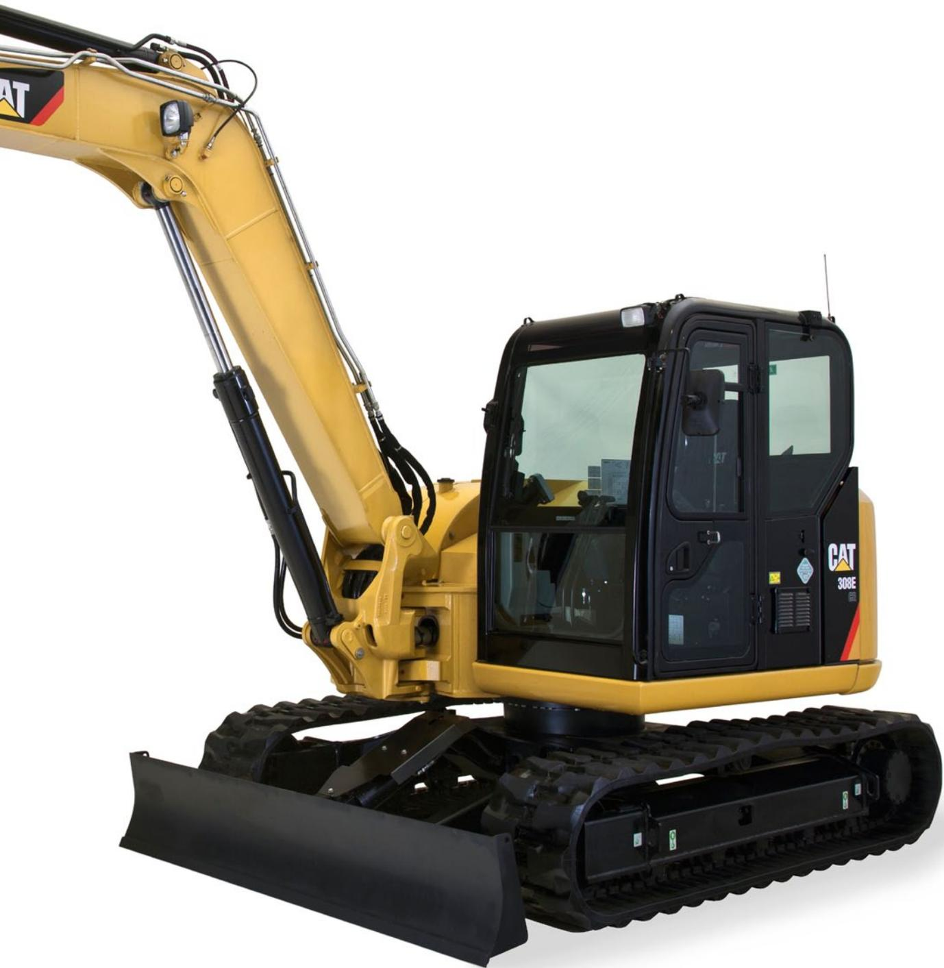
**Der Minibagger Cat® 308E CR SB bietet hohe Leistung mit der Vielseitigkeit einer Schwenkausleger-Löffelumlenkung in einem robusten Kurzheck-Design für Arbeiten in beengten Arbeitsbereichen. Durch die neue COMPASS-Anzeigetafel und die neugestaltete Arbeitsumgebung ist der 308E CR SB produktiver, vielseitiger und kostengünstiger.**
