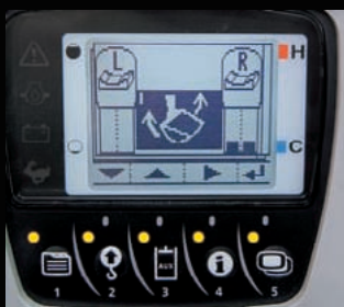
Max. Hydraulikölmengen – Einstellung (SP1 und SP2)
